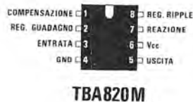
Fig.2 Connessioni del diodo varicap MVAM.115, del Mosfet 3N187 e del TBA820M.
